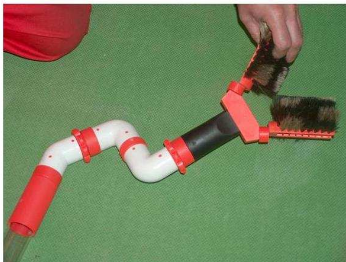
4. attēls Birste V-veida komplektā ar speciālo grozāmo savienojošo elementu 2 \times 90^\circ un savienojošo elementu 135^\circ – konstrukcija atļauj birstei griezties ap izolatoru
