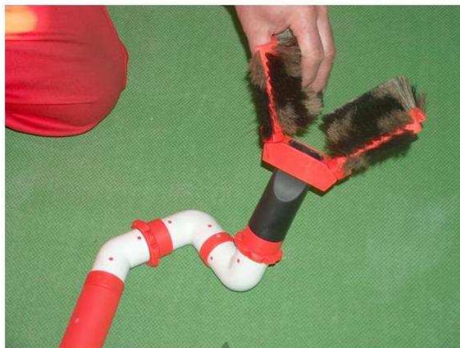
4. attēls Birste V-veida komplektā ar speciālo grozāmo savienojošo elementu 2 \times 90^\circ un savienojošo elementu 135^\circ – konstrukcija atļauj birstei griezties ap izolatoru
