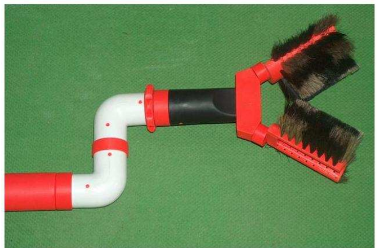
3. attēls Birste V-veida komplektā ar speciālo grozāmo savienojošo elementu 2 \times 90^{\circ}
